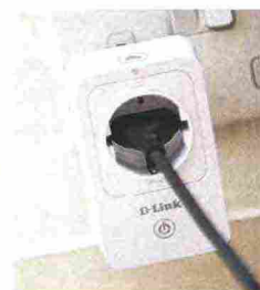
Oltre al controllo degli apparecchi elettrici, con la Smart Plug di D-link si può monitorare anche il consumo energetico.
